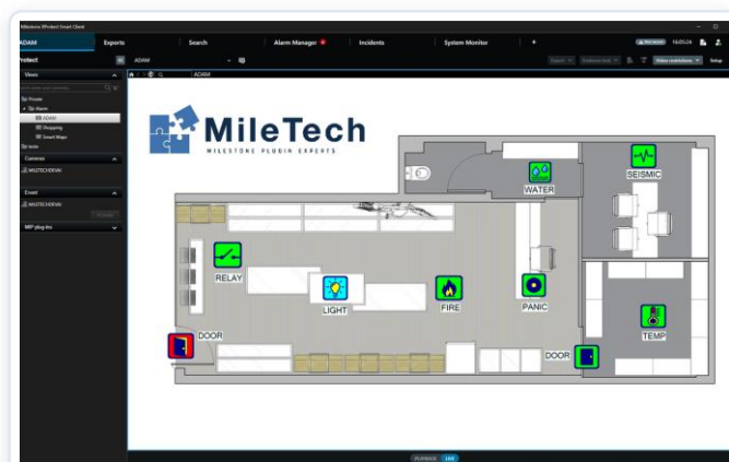
Eine offen gelassene Tür löst einen Alarm auf der Smart Client Karte aus
